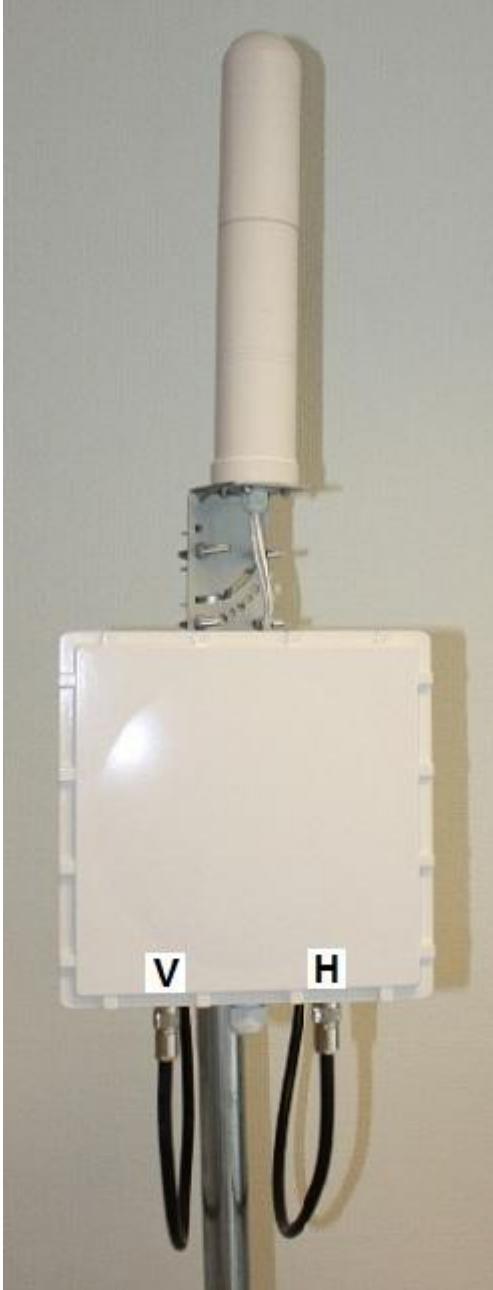
V-chain og H-chain sett forfra. Tilkobling av 2 stk. 1.5 meter lowloss kabler mot SEClink Base/Master enhet.
